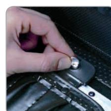
Фиксация панели с помощью поворотной защелки
